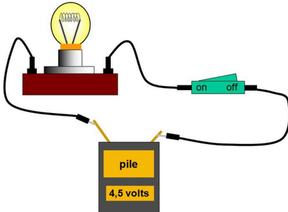
Une illustration montrant une pile connectée à une ampoule via deux fils et un interrupteur. L'ampoule s'allume lorsque les fils sont connectés à la pile et que l'interrupteur est sur "on".
