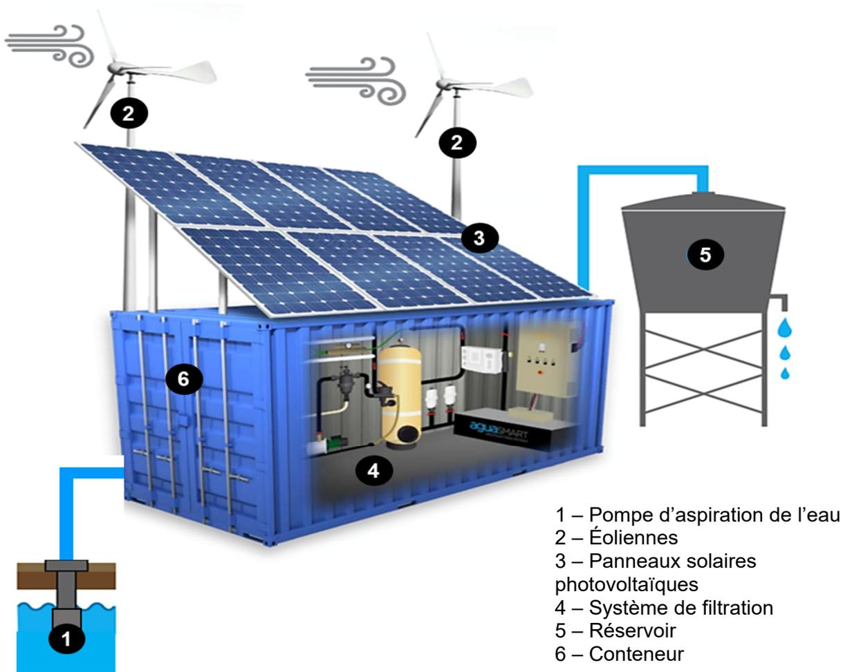
Le système est équipé de panneaux solaires photovoltaïques et de deux éoliennes pour créer sa propre énergie.
